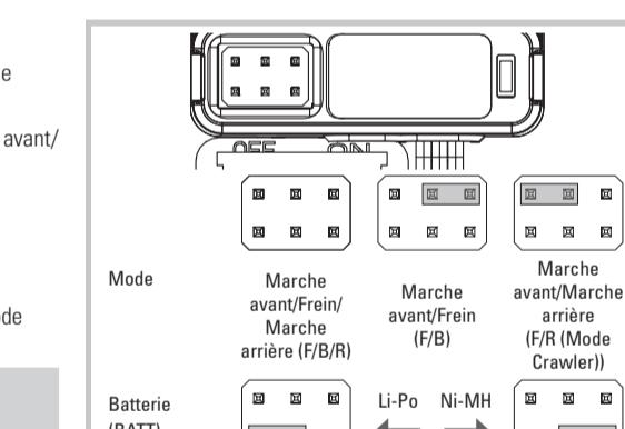
**REMARQUE:** Toujours débrancher la batterie du contrôleur quand vous n'utilisez pas le véhicule. L'interrupteur du contrôleur commande uniquement l'alimentation du récepteur et des servos. Même en position OFF, le contrôleur continue de consommer la batterie, risquant d'endommager la batterie à cause d'une décharge trop importante.
