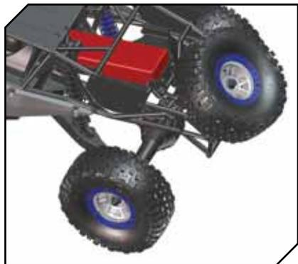
2 Lösen Sie die Rändelschraube um den Akkuhalter zu entfernen.
