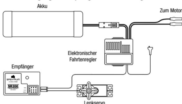
3. Nehmen Sie mit dem Gaszug, der Lenkung und dem Zusatzkanal die gewünschte Failsafe-Position ein. Leiten Sie den Bindeprozess an Ihrem Sender ein. Dieser wird die Failsafe-Positionen der einzelnen Kanäle übernehmen. Beachten Sie die Anmerkungen zum Failsafe im nächsten Abschnitt.
