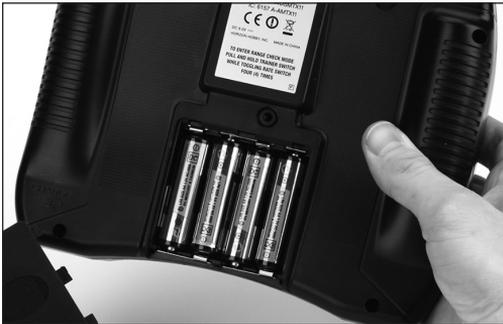
Rimuovere il coperchio del portabatterie e inserire le 4 pile AA, facendo attenzione alla polarità delle medesime indicata nel portatile. Rimettere il coperchio al suo posto.
