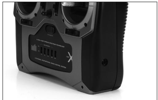
La presa di carica si trova sul fianco destro della trasmettente. Se si usano le batterie ricaricabili è possibile caricarle senza doverle estrarre dalla trasmettente tramite la presa.
