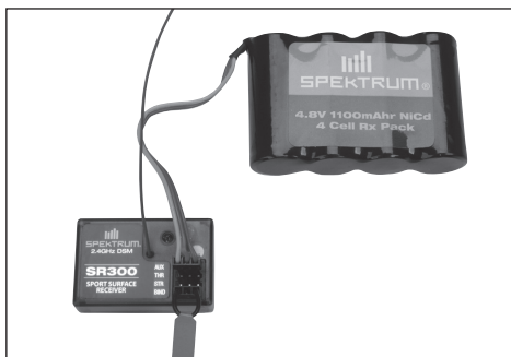
Qui sopra si vede il ricevitore SR300 alimentato da un pacco batterie separato.
