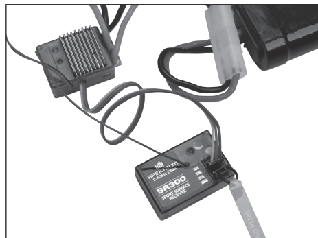
SR300 mit angeschlossenem Fahrtregler und einem Fahrakku Speedpack
