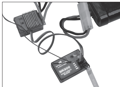
SR300 présenté ci-dessus avec un contrôleur électronique de vitesse ESC et un Dynamite® Speedpack™
