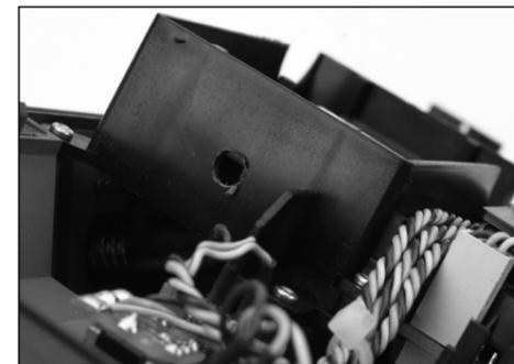
4. Applicare il gancio e l'elemento di fissaggio al nuovo modulo RF Spektrum e installarlo.
