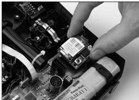
6. Inserire il collegamento del cavo facendo attenzione alla polarità. Cavo bianco in alto nella radio. Lo spazio tra il connettore ed il retro della radio sono minimi. Assicurarsi di mantenere i cavi adagiati in piano vicino al modulo.
