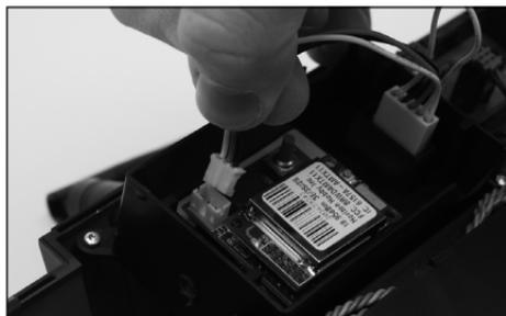
7. Cavo antenna di alimentazione. Connettere il modulo, facendo attenzione a non danneggiare il connettore.
