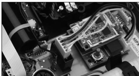
7. Cavo antenna di alimentazione. Connettere il modulo, facendo attenzione a non danneggiare il connettore.
