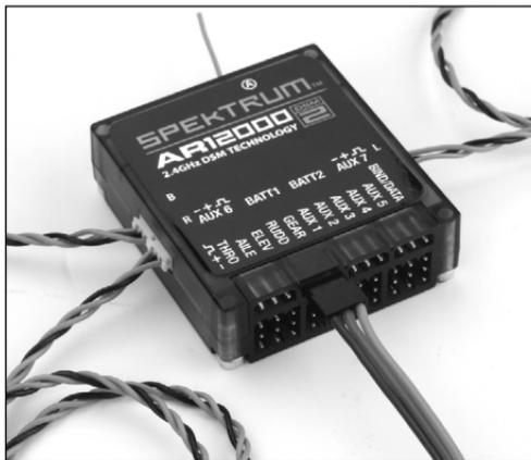
**Nota:** L'AR12000 necessita di almeno due ricevitori remoti per essere installato.
