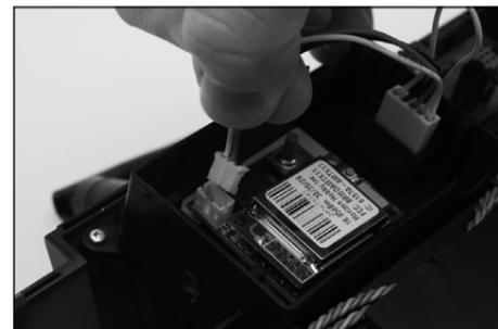
7. Verbinden Sie vorsichtig den Antennenanschluß mit dem Modul.
