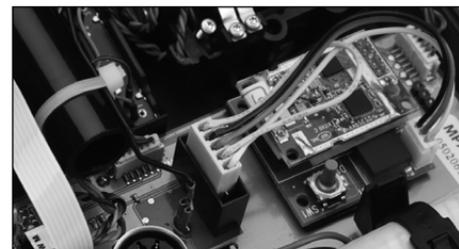
7. Câble d'alimentation de l'antenne. Connectez-le au module, en veillant à ne pas endommager le connecteur.
