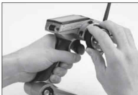
4. Respectez les procédures spécifiques à votre émetteur pour aller en mode affectation. Le système se connectera en quelques secondes. Une fois la connexion établie, la DEL du récepteur reste allumée, indiquant que le système est connecté.
