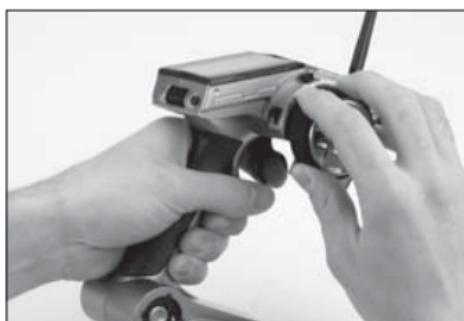
4. Seguire le procedure specifiche per il trasmettitore per iniziare la modalità di collegamento; il sistema si connetterà in pochi secondi. Dopo la connessione, il LED sul ricevitore rimarrà fisso, indicando che il sistema è connesso.
