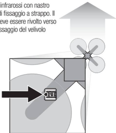
**IMPORTANTE:** il ricevitore a infrarossi deve essere rivolto verso il modulo Gate quando il velivolo attraversa il varco. Non montare il sensore rivolto in avanti o indietro.
