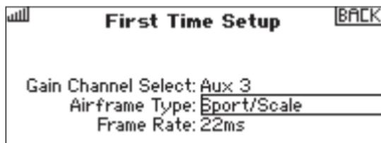
3. Passare a Frame Rate (Tasso di frame) e selezionare il frame rate desiderato. Il tasso di frame selezionato regolerà il frame rate della risposta del ricevitore e del modulo AS3000 ai servi. Il tasso di frame è applicato a tutti i canali da 1 a 12 (da 13 a 20 sono sempre 22 ms), non solo alle uscite assegnate al giroscopio.
