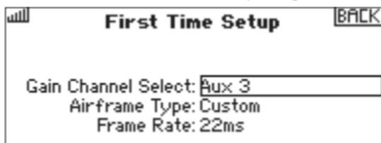
2. Passare all'opzione Airframe Type (Tipo cellula). È possibile scegliere tra 2 tipi di modello: Sport/Scale e 3D. Queste opzioni impostano i valori di sensibilità massimi per ciascun asse e il canale di sensibilità selezionato regola la sensibilità per tutti gli assi su o giù. Selezionare il tipo appropriato per il proprio aeromodello.
