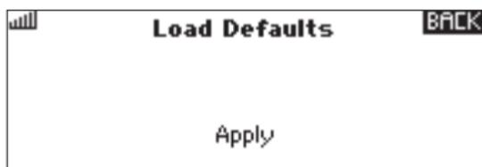
**SUGGERIMENTO:** Il ricevitore può essere forzato al ripristino delle impostazioni di default inserendo una spina di binding e ripetendo per 5 volte di seguito accensione e spegnimento. Tutti i LED inizieranno a lampeggiare simultaneamente per indicare che i valori predefiniti sono stati impostati. Ciò aiuterà a resettare le impostazioni nel caso sia impostato un orientamento errato e il ricevitore non possa essere inizializzato a usare il reset di fabbrica del Forward Programming.
