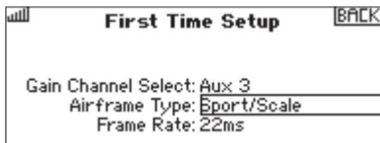
3. Faites défiler jusqu'à Frame Rate (Taux de rafraîchissement), et sélectionnez le taux de rafraîchissement souhaité. Le taux de rafraîchissement sélectionné ajustera le taux de rafraîchissement de la réponse du récepteur et de l'AS3000 aux servos. Le taux de rafraîchissement est appliqué sur tous les canaux de 1 à 12 (les canaux 13 à 20 sont toujours à 22 ms), pas seulement sur les sorties attribuées aux gyros.
