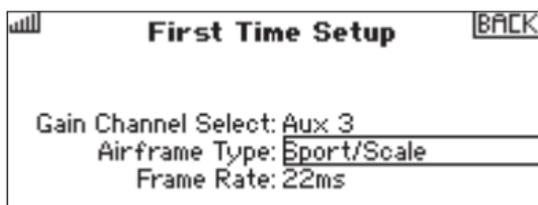
3. Zu „Frame Rate“ [Bildfrequenz] scrollen und die gewünschte Bildfrequenz auswählen. Die ausgewählte Bildfrequenz wird die Bildfrequenz der Antwort des Empfängers und von AS3000 an die Servos anpassen. Die Bildfrequenz wird auf alle Kanäle von 1 bis 12 (13 bis 20 sind immer 22 ms) angewendet und nicht nur auf die vom Kreiseln zugewiesenen Ausgänge.
