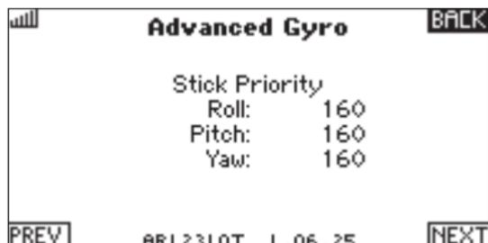
Die Standardeinstellung liegt bei 160, was bedeutet, dass die Verstärkung bei 40 % Knüppel eingabe auf 0 geht. Die maximale Einstellung liegt bei 200, was bedeutet, dass die Verstärkung kurz vor der mittigen Position des Knüppels auf 0 geht.
