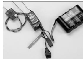
Hier die Empfängerstromversorgung mit einem separaten Akku. Das Akku kann in einen beliebigen Anschluß gesteckt werden.
