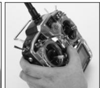
4. Respectez les procédures spécifiques à votre émetteur pour passer en mode affectation. Le système se connectera en quelques secondes. Une fois la connexion établie, la DEL du récepteur reste allumée, indiquant que le système est connecté.
