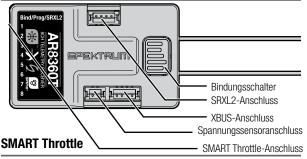
Der Gasanschluss des Empfängers AR8360T bietet SMART Throttle. Bei der Ausstattung mit SMART Throttle liefert der normale Servo-Anschluss das Gassignal an den Geschwindigkeitsregler, und der Geschwindigkeitsregler kann Telemetriedaten wie Spannung und Stromstärke an den Empfänger zurücksenden. Der Gasanschluss des AR8360T-Empfängers erkennt automatisch, wenn ein mit SMART Throttle kompatibler Geschwindigkeitsregler angeschlossen ist. und schaltet in den Modus "SMART Throttle".
