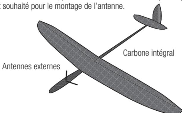
Glissez l'antenne dans le trou, laissez dépasser à l'extérieur du fuselage les 31mm de la partie active et 2mm du coaxial. Utilisez une goutte de colle CA pour coller l'antenne au fuselage. Contrôlez que la partie active de l'antenne (les 31mm en partant de l'extrémité) est entièrement exposée.
