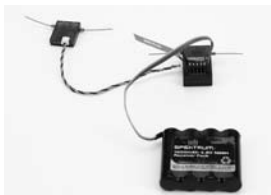
Abbildung mit separatem Empfängerpack. (Akku kann an einen beliebigen offenen Anschluss angeschlossen werden.)
