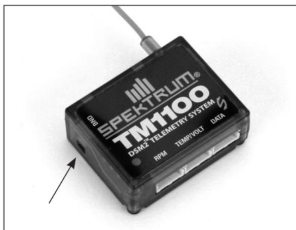
2. Mentre si preme il pulsante di collegamento, alimentare il ricevitore. Il ricevitore principale, tutti i ricevitori remoti connesso e il modulo in telemetria TM1100 lampeggeranno indicando che il sistema è in modalità di collegamento.
