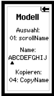
Nutzen Sie die Modellauswahlfunktion um einen Modellspeicher zu wechseln, einen Namen zu vergeben oder ein Modell zu kopieren. Die DX4R PRO ist mit 50 Modellspeicher ausgestattet.
