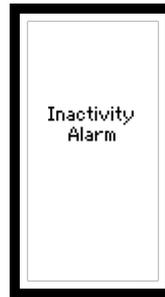
Dieser Alarm erinnert Sie daran den Sender auszuschalten und so Batteriekapazität zu sparen. Ist der Sender ohne Steuereingabe länger als 10 Minuten eingeschaltet ertönt der Inaktivitätsalarm. Das Bewegen eines Bedienelementes schaltet den Alarm ab.
