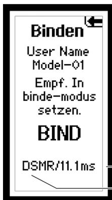
Unter Binden versteht man das Übermitteln des Senderspezifischen Signals (auch GUID Globally Unique ID) bezeichnet und das Speichern von Failsafe-Werten. Wenn ein Empfänger an einen Sender/ Modellspeicher gebunden ist, reagiert der Empfänger nur auf diesen speziellen Sender/ Modell-speicher (weitere Informationen finden Sie unter ModelMatch).
