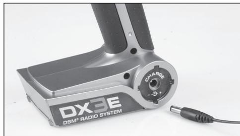
On peut également utiliser des batteries rechargeables AA NiMH 1,2 V optionnelles (SPM9525). En cas d'utilisation de batteries rechargeables, celles-ci peuvent facilement être rechargées sans les extraire de l'émetteur en utilisant la prise de charge se trouvant sur l'arrière du boîtier de l'émetteur.
