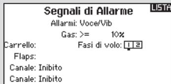
Questo menu consente di programmare un tono o una vibrazione per avvisare che un certo interruttore o canale si trova nella posizione selezionata. L'allarme si attiva e compare anche un messaggio di avvertimento se, quando si accende il trasmettitore, un certo interruttore o comando si trova in una posizione pericolosa.
