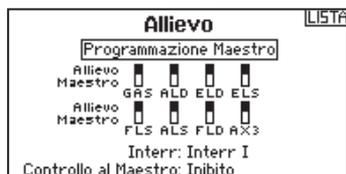
La modalità Master Programmabile consente di programmare il trasmettitore del maestro a trasferire i canali tutti o singolarmente quando si attiva l'interruttore
