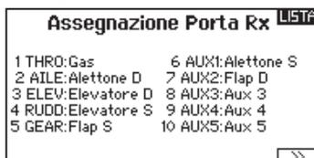
In questa schermata si può riassegnare quasi ogni canale del ricevitore ad un diverso canale sul trasmettitore. Ad esempio il canale del carrello sul ricevitore, si può riassegnare utilizzando il canale del motore sul trasmettitore.
