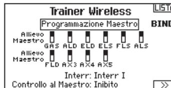
La modalità Master Programmabile consente di programmare il trasmettitore del maestro a trasferire i canali tutti o singolarmente quando si attiva l'interruttore
