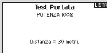
La funzione per la prova della portata riduce la potenza in uscita. Ciò consentirà di confermare che il collegamento RF funziona correttamente. Effettuare una prova
