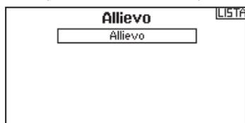
Si usa questa modalità quando il trasmettitore DX18t viene usato come Slave e il Pilot Link è attivo sul trasmettitore Master.
