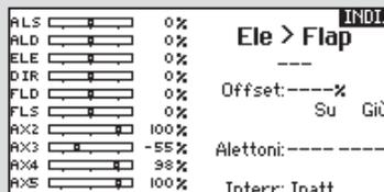
Abbinando il flap al comando dell'elevatore si genera una portanza aggiuntiva per stringere le virate. L'intero bordo di uscita dell'ala (alettone + flap) qui lavora come
