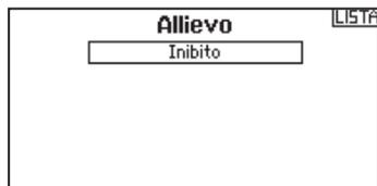
Il trasmettitore allievo deve avere la stessa programmazione del trasmettitore maestro (inversione servi, regolazione corse, sub trim, ecc.).
