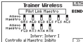
Questa modalità consente di programmare il trasmettitore del maestro a trasferire i canali tutti o singolarmente quando si attiva l'interruttore Trainer. Pilot Link Master
