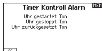
Wählen Sie in diesem Menü Aus, Ton oder Sprachausgabe für die Funktionen Uhr gestartet, Uhr gestoppt und Uhr zurückgesetzt.
