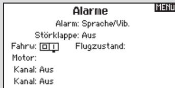
Mit der Alarmfunktion können Sie einen Audio- oder Vibrationsalarm bestimmten kritischen Schalterpositionen zuordnen, die dann ertönen wenn Sie bei dem Einschalten des Sender aktiv sind. Tritt diese kritische Bedingung ein ertönt ein Alarm und auf dem Display erscheint eine Warnung so lange bis der Knüppel oder Schalter wieder zurück in die sichere Position gebracht wird.
