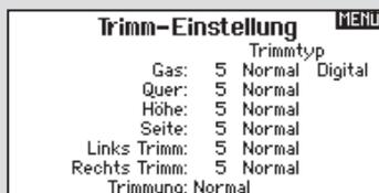
Die Trimmschrittfunktion erlaubt es den Trimbereich der Servos in unterschiedlich große oder kleine Trimmschritte einzuteilen und den Trimmtyp zu ändern.
