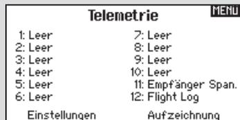
Das Telemetriemenü befindet sich in der Systemeinstellung und Funktionsliste, so dass Sie aus beiden Ebenen auf diese Funktion zugreifen können. Um die Telemetriedaten zu löschen müssen Sie den Sender und Empfänger ausschalten. Min und max Werte können mit Druck auf den Clear Button gelöscht werden.
