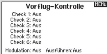
Mit der Vorflugkontrolle können Sie eine Checkliste programmieren die jedes Mal bei dem Einschalten des Senders erscheint oder wenn Sie einen neuen Modellspeicher wählen. Jeder Punkt der Checkliste muß bestätigt werden bevor Sie das Hauptdisplay sehen.
