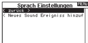
Mit dieser Funktion können Sie Benutzerdefinierte Alarme oder Ereignisse generieren. Sie können mit dieser Funktion zum Beispiel mit einem Schalter-Ereignis oder Sprachablauf durch die Sprachausgabe informiert werden. Um eine neues Ereignis hinzuzufügen gehen Sie in das Menü Sprach Einstellungen und wählen
