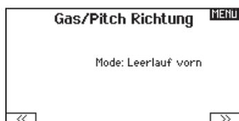
In diesem Menü wählen Sie ob sie Gas/Pitch drücken oder ziehen möchten. Die verfügbaren Mode sind Leerlauf hinten /Leerlauf vorne. Sie erreichen dieses
