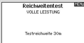
Der Reichweitentest reduziert die Ausgangsleistung. Damit kann überprüft werden ob die Funkverbindung korrekt funktioniert.
