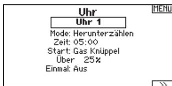
Mit der DX18t Uhr können Sie eine Stopuhr oder Countdownfunktion aktivieren die auf dem Hauptdisplay angezeigt wird. Ist die programmierte Zeit um hören Sie
