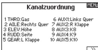
In der Kanalzuordnung ordnen Sie alle Ausgangskanäle zu, inklusive Schalter, Schieber, Knöpfe oder Steuerknüppel. So kann zum Beispiel der Fahrwerkskanal geändert zu dem Gaskanal werden.
