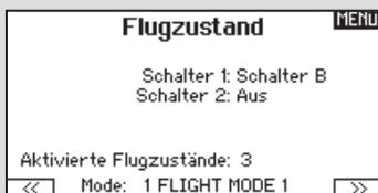
Verwenden Sie die Setup Funktion der Flugzustände um diese zu aktivieren, Mischer zu zuordnen oder Kanäle auf einzelne Schalter zu legen.
