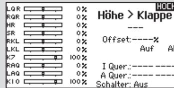
Der Höhenruder zu Klappe Mischer erzeugt mehr Auftrieb und ermöglicht engere Kurven. Die gesamte hintere Kante der Tragfläche (Querruder und Klappen)
