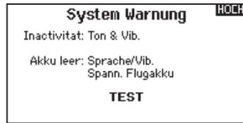
In diesem Menü ordnen Sie dem Inaktivitäts- und Spannungsalarm die Spachausgabe und Vibration oder Ton/ Vibration zu.
