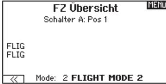
Sie können die verfügbaren Flugzustände (bis zu 5 für Flugzeug, bis zu 10 für Segelfluggzeuge) auf jeden der Schalterpositionen (es können bis zu drei Schalter für Segelfluggzeuge und zwei Schalter Motorflugzeuge verwendet werden) zuordnen. Drücken Sie >> Weiter aus dem Menü Flugzustand um in die Auswahl zu gelangen wenn Sie benutzerdefinierte Flugzustände gewählt haben. Die Kombination von 2 bis 3 Schaltern kann verwendet werden um alle verfügbaren Flugzustände zu erreichen.
