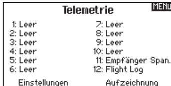
Mit dem Einbau der optionalen Telemetriemodule und Sensoren können Sie Echtzeitleistungsdaten des Modells auf dem Senderdisplay sehen. Sie können auch die Telemetriedaten auf der SD Karte speichern und in dem Spektrum StI APP ansehen.
