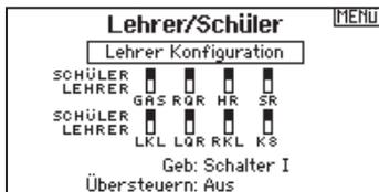
In der Lehrer Konfiguration können Sie programmieren ob bei der Aktivierung des Schalters einige oder alle Kanäle übergeben werden. Diese Funktion
