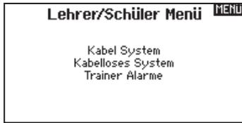
Die DX18t ist mit 4 Kabel-gebundenen und 2 Kabel-losen Trainer-modes ausgestattet. Die Lehrer/ Schüler Funktion ist dem Schalter I zugeordnet.
