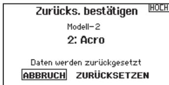
Nutzen Sie die -Modell zurücksetzen Funktion- um die gesamte Programmierung eines Modellspeichers zu löschen. Alle Werte auf dem spezifischen Speicherplatz werden damit auf Standardwerte zurückgesetzt.
