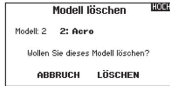
Mit dieser Funktion können Sie ein Modell dauerhaft aus der Modellliste löschen. Sollten Sie das nicht vorhaben wählen Sie Abbruch um das Menü zu verlassen.
