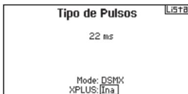
Los canales AUX6 y AUX7 están disponibles en los receptores de 12 canales cuando X-Plus está activo. AUX6 y AUX7 son canales con una resolución de 2048 y un rango de velocidad de 22ms (*sólo receptores de 12 canales*).
