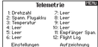
Ändern Sie NIEMALS die Telemetrieinstellungen wenn das Luftfahrzeug eingeschaltet ist da bei Verlassen des Menüs das HF Teil kurz unterbrochen wird.
