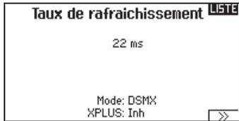
Les voies AUX6 et AUX7 sont disponibles sur les récepteurs 12 voies quand le X-Plus est activé. AUX6 et AUX7 ont une résolution de 2048 et un taux de rafraîchissement de 22ms (*récepteurs 12 voies uniquement*).
