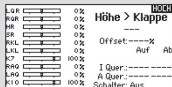
arbeitet dabei als Klappe wenn Höhenruder gesteuert wird. Ein Offset ist auch verfügbar der typischerweise als Snap Flap Funktion verwendet wird. Bei der Snap Flap Funktion bleibt der Mischer inaktiv bis der Offset Wert erreicht ist. Normalerweise werden hier 70% Höhenruder nach oben programmiert, so dass bei Ruder-eingaben über 70% der Mischer aktiv wird und mehr Auftrieb für engere Kurven zur Verfügung steht.
