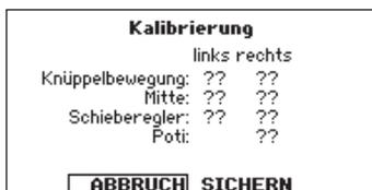
Sie die Steuerknüppel vorsichtig in die Ecken um eine akkurate Kalibrierung zu erhalten. Führen Sie beide Steuerknüppel zurück in die Mittenposition.
