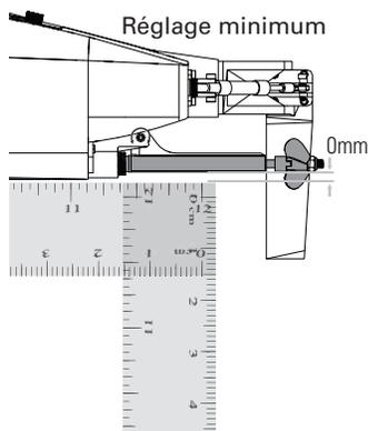
7. Réglez la chaise d'hélice par intervalle de 0,5 à 1 mm. Notez les réglages de la première chaise d'hélice et répétez l'opération pour la deuxième. Le bateau est sensible au réglage de l'angle de la chaise d'hélice.
