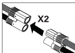
2. Schließen Sie beide Akkus an die Regleranschlüsse an.
