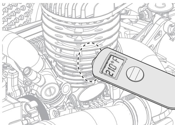
**HINWEIS:** Die Motortemperatur wird am Zylinderfuß gemessen und nicht am Kopf wie bei Nitromotoren.
