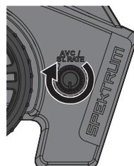
Girare in senso antiorario il pannello ST RATE per ridurre la sensibilità.
