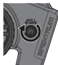
Drehen Sie den ST Rate Drehknopf gegen den Uhrzeigersinn um den Gainwert zu reduzieren.
