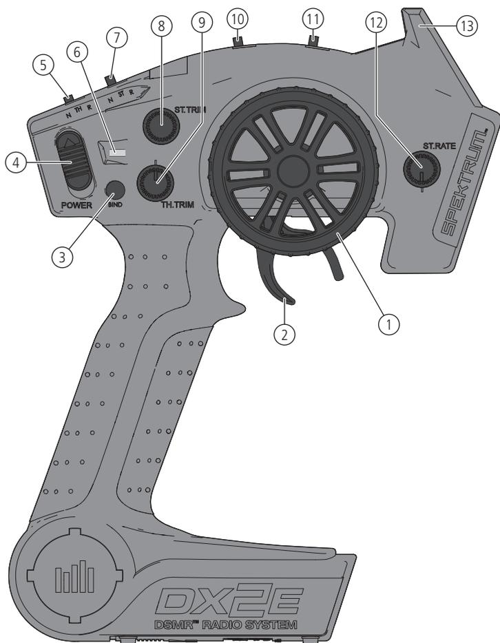
1. **Steuerrad** Steuert die Richtung (links/rechts) des Modells
