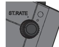
Faites tourner le potentiomètre ST RATE dans le sens anti-horaire pour réduire la sensibilité.
