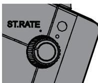
Girare in senso antiorario il pannello ST RATE per ridurre la sensibilità.
