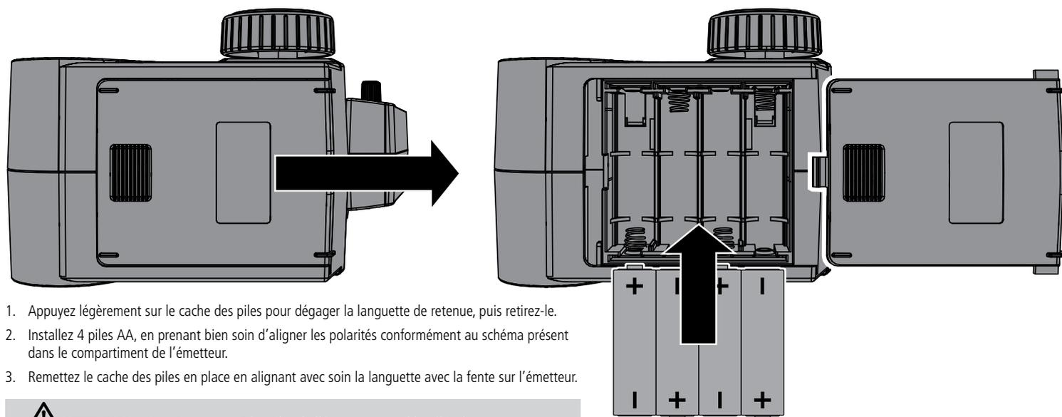
1. Appuyez légèrement sur le cache des piles pour dégager la languette de retenue, puis retirez-le.
