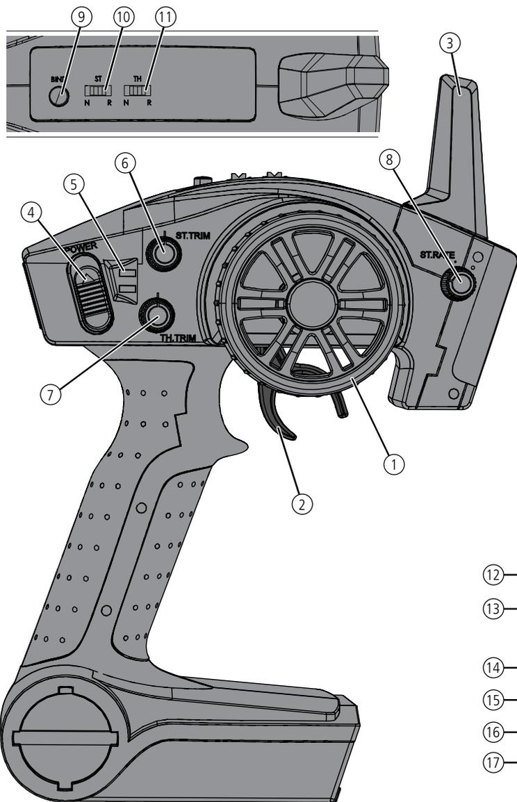
1. **Volant de direction** Commande la direction (gauche/droite) du modèle
