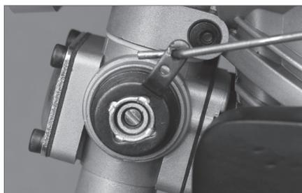
1. Usare un metodo sicuro per collegare la barretta di comando al braccio sul carburatore.
