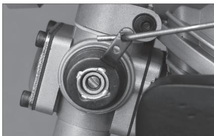
1. Utiliser une méthode sûre pour fixer la tringlerie des gaz au palonnier des gaz du carburateur.
