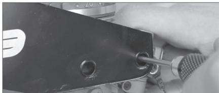
1. Placez une rondelle frein sur chaque vis de fixation du silencieux. Glissez les vis au travers du silencieux.
