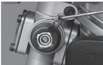
1. Verwenden Sie zum Anbringen des Gasgestänges an den Gasarm des Vergasers eine sichere Methode.
