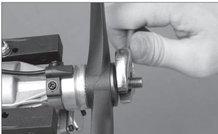
1. Entfernen Sie die Propellermutter und die Propellerscheibe von der Kurbelwelle.
