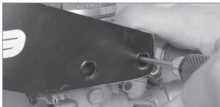
1. Setzen Sie einen Federring auf jede der Schalldämpferschrauben. Stecken Sie die Schrauben durch den Schalldämpfer.
