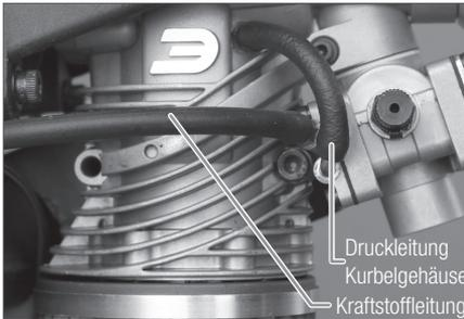
1. Schließen Sie den Medium Kraftstoffschlauch an den Kraftstoffanschluss des Tanks und an den Vergaser an.
