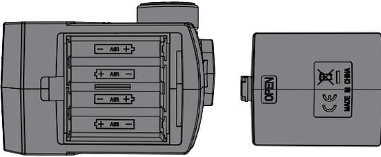
Installez 4 piles alcalines dans l'émetteur en suivant les instructions fournies pour votre système radio.
