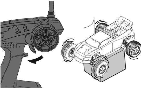
4. Commencez par rouler lentement et si le véhicule ne roule pas droit, réglez la direction à l'aide du potentiomètre du trim de direction.
