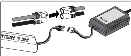
Le chargeur a une intensité de charge de 2A par heure (2000mAh). Divisez par 2000 la capacité de votre batterie (indiquée sur son étiquette) pour connaître le temps de charge requis. Par exemple, une batterie de 1800mAh nécessite 0.9H (54 minutes) pour être chargée.
