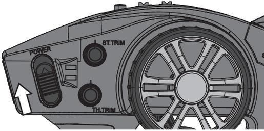
2. Verbinden Sie den Fahrakku mit dem Regler und schalten den Regler ein.
