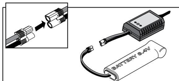
Il caricabatterie per la batteria del motore ha una corrente di carica di 2000 mAh (2 Ah). Dividendo la capacità in mAh indicata sull'etichetta della batteria per 2000, si ottiene il tempo necessario alla sua carica. Per esempio una batteria scarica da 2400 mAh richiede circa 1,2 ore (72 min.) per la ricarica.
