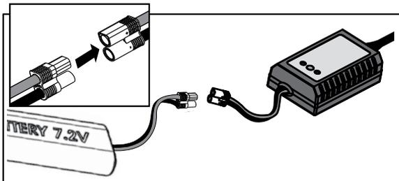
Das Ladegerät lädt mit 2,0A (2000 mAh) per Stunde. Dividieren Sie die auf dem Akkuetikett angegebene mAh Kapazität durch 2000 um die erforderliche Ladezeit zu errechnen. So benötigt zum Beispiel ein 2400mAh Akku 1,2 Stunden = 72 Minuten zum laden.
