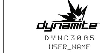
Wird das Ladegerät eingeschaltet (ON) erfolgt eine Serie von Selbsttests und im Display wird der Name des Ladegerätes und die Modellnummer angezeigt.
